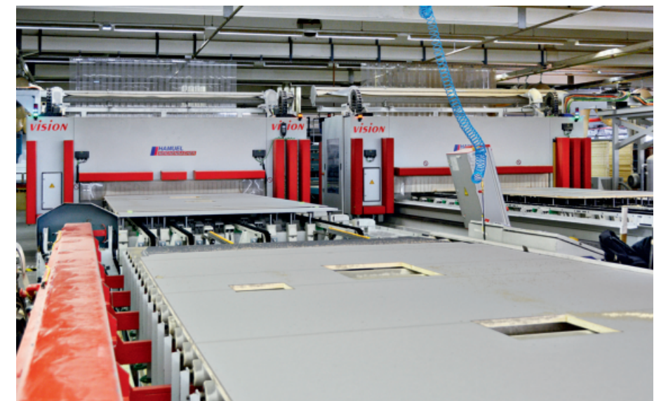
Linienfertigung der Außenkorpusse auf drei Anlagen der Baureihe „Vision“
